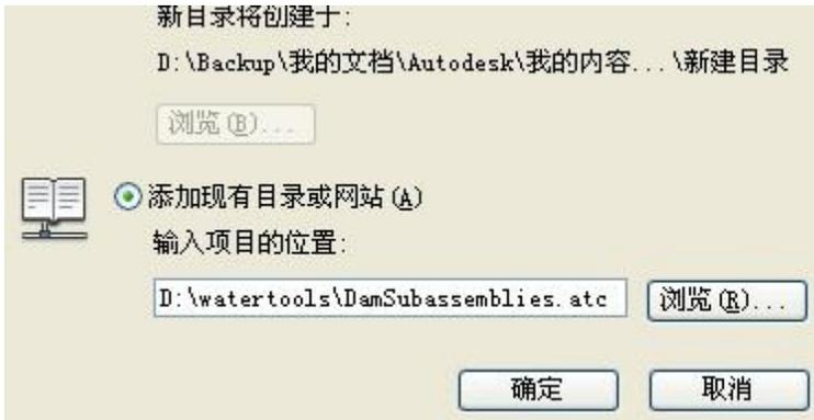
进入目录中，如下左图，将其拖到工具选项板，如果无法直接拖动，在部件图标上点右键复制，再到工具板上粘贴即可。如下右图。
