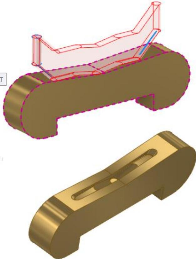
Das nächste Beispiel zeigt, wie sich die Verwendung einer 90-Grad-Drehung in einem Ausgerichtet-Sweeping zur Konstruktion einer Zufuhrschnecke, die eine Flasche von horizontal nach vertikal dreht, auswirkt.
