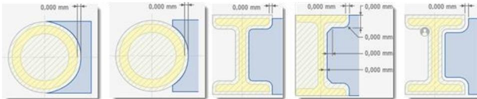
Aktivieren Sie die neue Option Rechtwinklig schneiden, um präzise Schnittpunkte zu erstellen.
