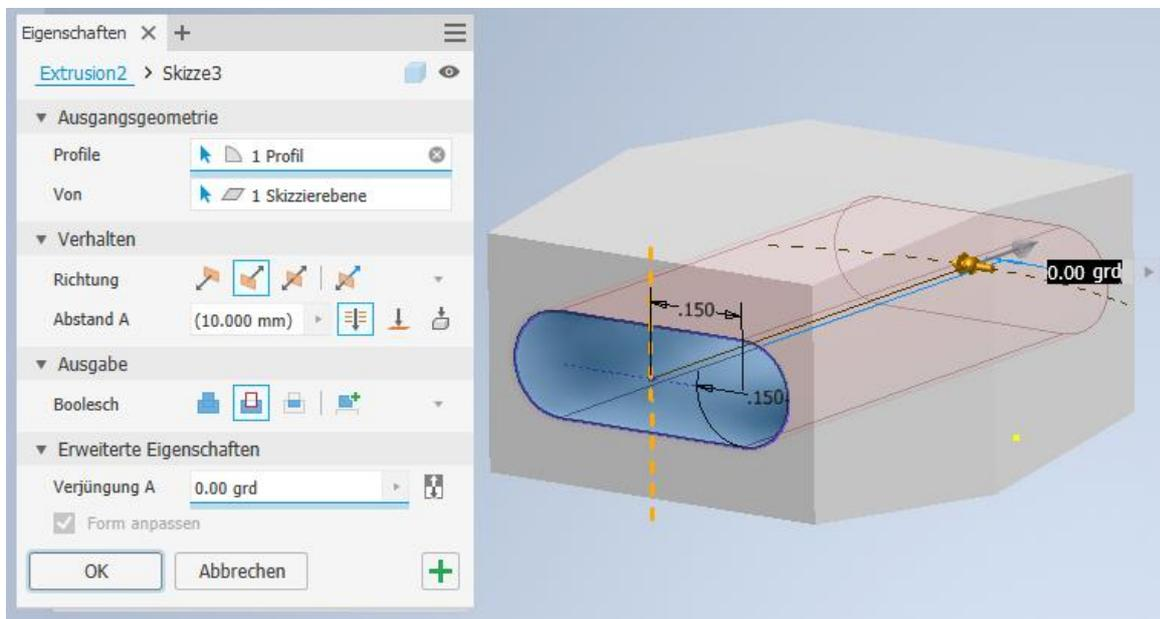
Bei Verwendung der Option Verjüngung mit angrenzenden Bereichen werden mit diesem Vorgang die Flächen zusammengeführt, sodass ein einzelnes, einheitliches Ergebnis entsteht.
