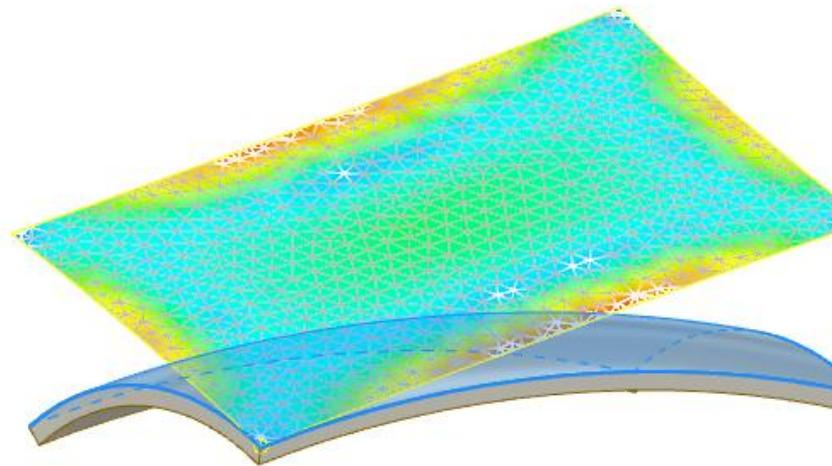
**Tip:** Unterdrücken Sie Prägungselemente auf einem Blechbauteil, um die Abwicklung zu berechnen, und heben Sie anschließend die Unterdrückung auf, und wickeln Sie die geprägten Bereiche einzeln ab.
