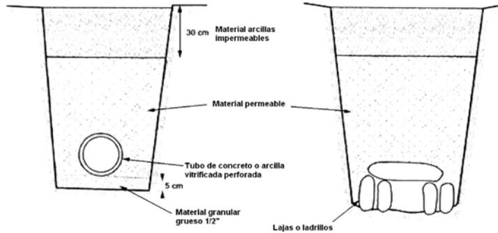
Figura 4.2.3b: Subdren de aguas subterráneas con geotextil
